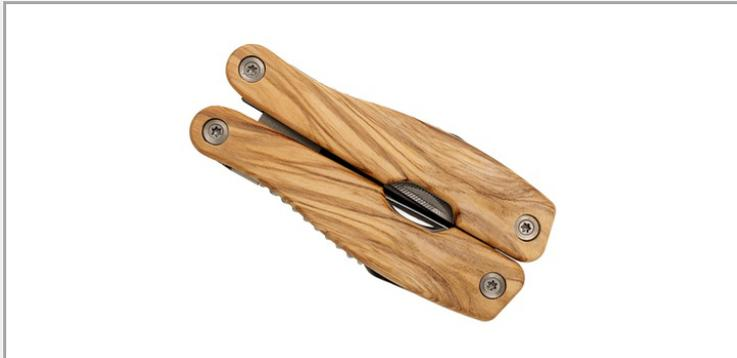
Professionelle Multifunktionszange aus hochfestem Edelstahl (2CR13). Griff aus Olivenholz. Montage mit Torx-Schrauben. Neue Generation der Sicherheitsverriegelung (einfaches Entriegeln). 12 Funktionen: Universalzange, Seitenschneider, Messer, Feile, Dosenöffner, Flaschenöffner, Säge, Mini-Stanzwerkzeug, 3 verschiedene Größen von Schlitzschraubendrehern, Kreuzschlitzschraubendreher. Wird mit einer Gürteltasche aus Nylon geliefert.
