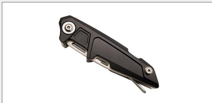
Outil multifonctions professionnel en acier inoxydable hautement résistant (2CR13). Manche en aluminium. Assemblage vissé Torx. 17 fonctions : pince, pince coupante, couteau, décapsuleur, ouvre-boîte, 2 tailles de tournevis plat, assortiment de 9 outils (tournevis cruciformes, plats, clés Allen), dénudeur. Dureté rockwell : 48 degrés. Livré dans un étui gris chiné en RPET.
